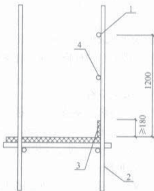
图 7.3.12 栏杆与挡脚板构造
