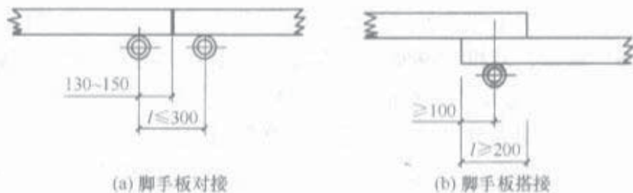
图 6.2.4 脚手板对接、搭接构造
