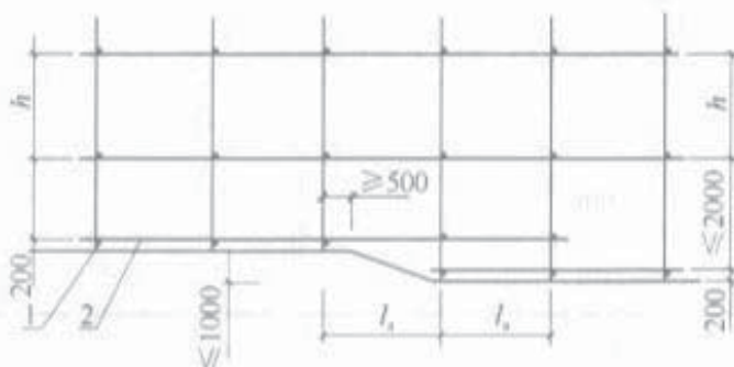
图 6.3.3 纵、横向扫地杆构造
