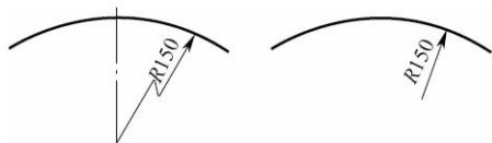
图 11.4.3 大圆弧半径的标注方法
