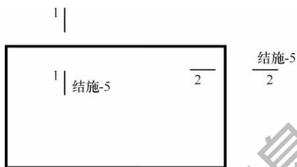
图 7.1.4-2 断面的剖切符号
